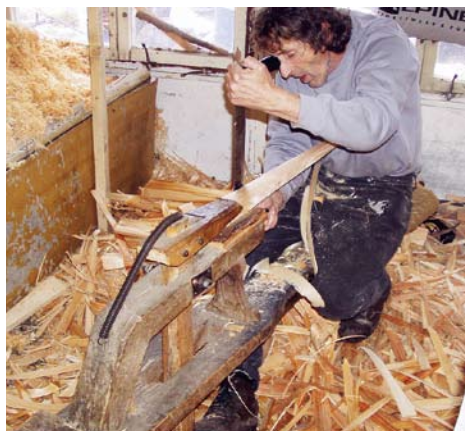
Úprava hrany šindele. (Foto V. Kolmačka)
