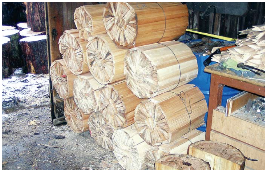
Šindele se tradičně transportují svázané do balíků. (Foto V. Kolmačka)
