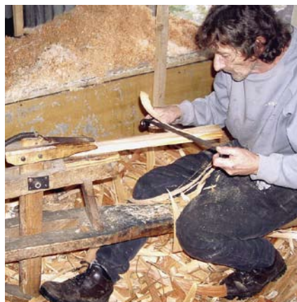
Strouhání šindele. (Foto V. Kolmačka)
