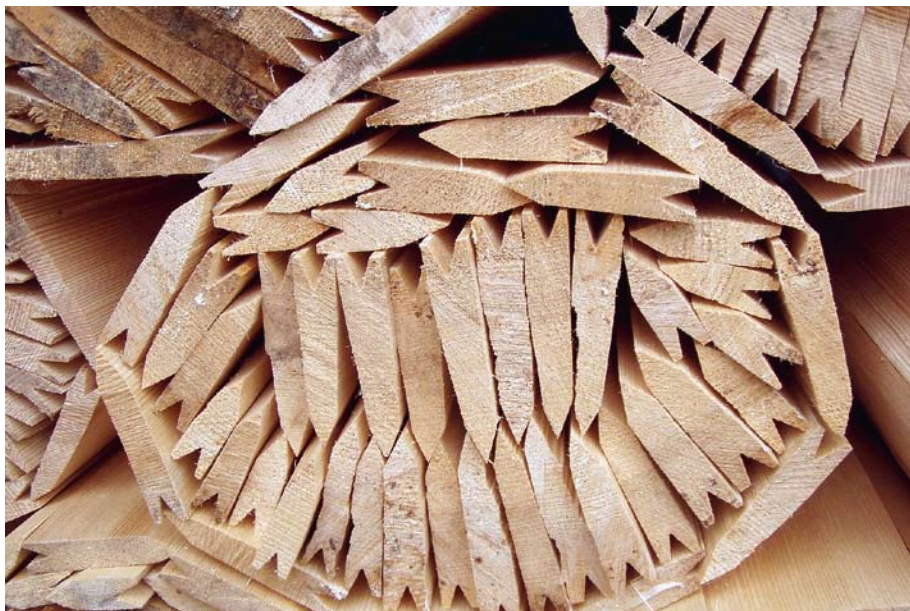
Detail šindelů svázaných o balíku. (Foto V. Kolmačka)
