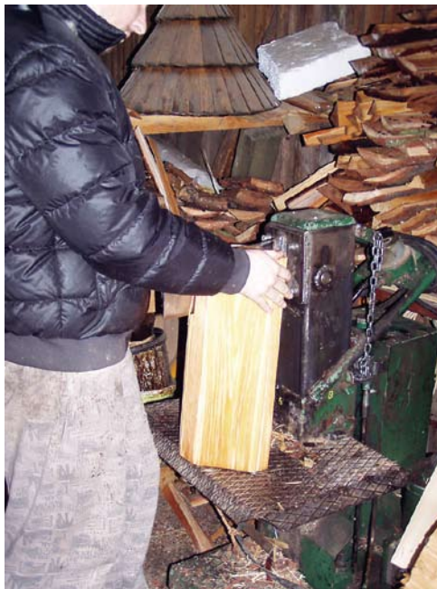
Čtorecní špalku na štípačce. (Foto V. Kolmačka)
