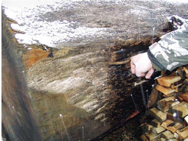
Nerovnost kmene – zvlnění vláken v podélném směru. (Foto V. Kolmačka)
