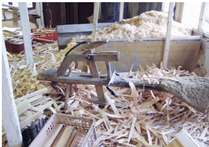
Nástroj na výrobu šindele – strýc a poříz. (Foto V. Kolmačka)
